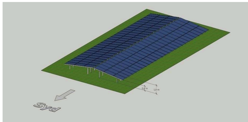
Figur 6. Illustration af fixed-tilt E/W.
